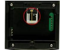
Coloque la tarjeta microSDHC y empújela dentro de la ranura
